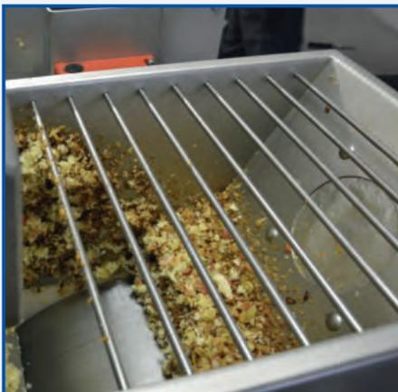
Die Äpfel werden mit einer Maschine fein geschnitten.
