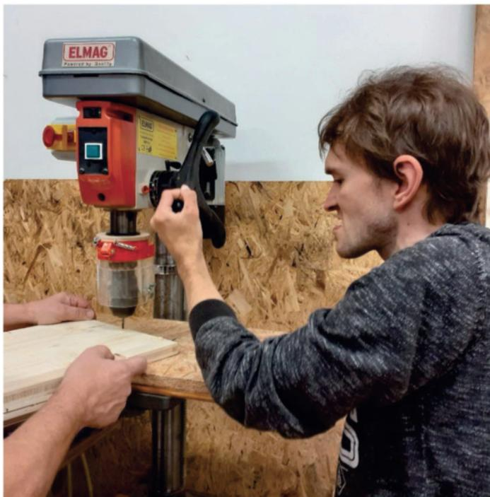
*Nico bohrt mit der Ständer-Bohrmaschine die Löcher.*
